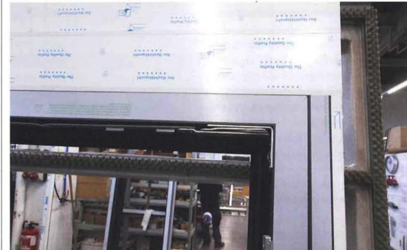
*AluConnect kann auch mit Unterbauprofilen, Verbreiterungen, Aufdopplungen etc. aus dem System Softline 82 kombiniert werden.*
