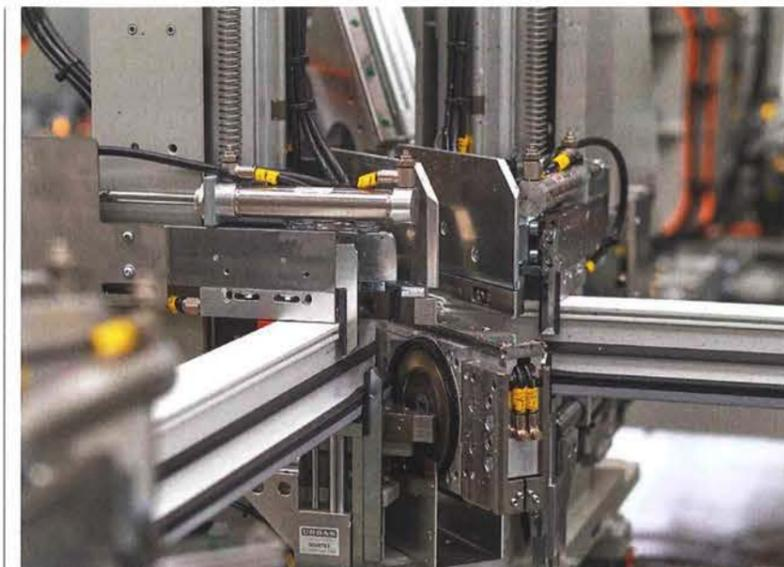
Mit der in die vier Schweißköpfe integrierten Fräseinheit werden die Aluminium-Profile zurückgefräst, so wird das Verschweißen der Profile ermöglicht. Foto: Ingo Jensen / Urban
