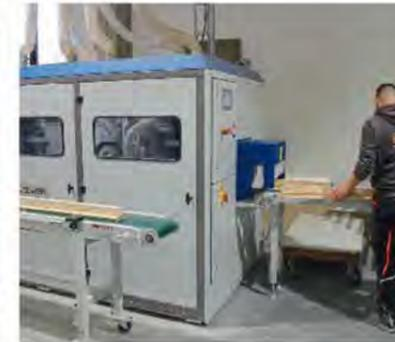
/ Basis für feines Finish: Der Schleifautomat mit automatischer Einstellung unterschiedlicher Profile.
