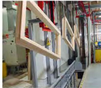
/ Der Einlaufbereich zur Finiture-Flutanlage: Ergonomisches Be- und Entladen durch die Absenkstation.
