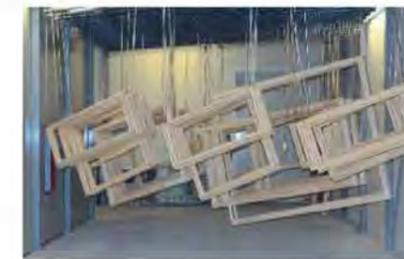
/ Der Trockentunnel arbeitet mit exakt einstellbaren Trocknungsparametern im Umluftverfahren.
