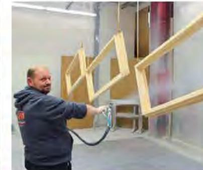
/ Derzeit erfolgt der Spritzauftrag in manueller Arbeitsweise an der Trocken-Spritzkabine.
