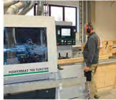
/ Beste Massivholz-Bearbeitungstechnik von Weinig: Hobeln und Profilieren samt Glasleistenaustrennung.
