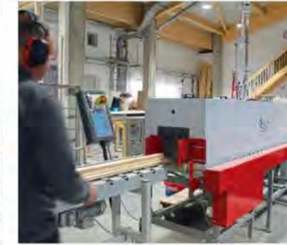
/ Der Imprägniertunnel von Finiture kann wässern und imprägnieren der Einzelteile vor dem Schleifen.
