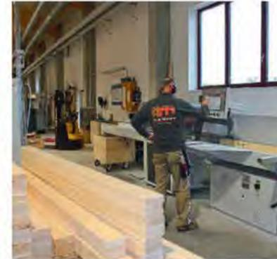
/ An der Opticut-Kappsäge: 3-fach verleimte Fensterkanteln werden kommissionsweise zugeliefert.
