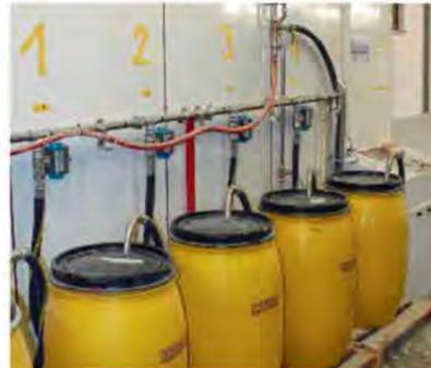
/ Für den automatischen Wechsel: Mehrere Farben stehen in den Lackbehältern immer auf Abruf bereit.
